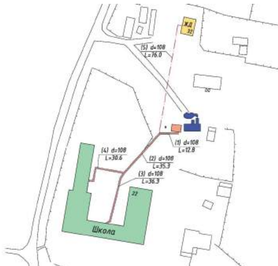
Рисунок 1.3.2. Схема тепловой сети от котельной д.Веригинская
